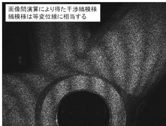
図9 荷重0~1.5kgfの干渉縞画像
