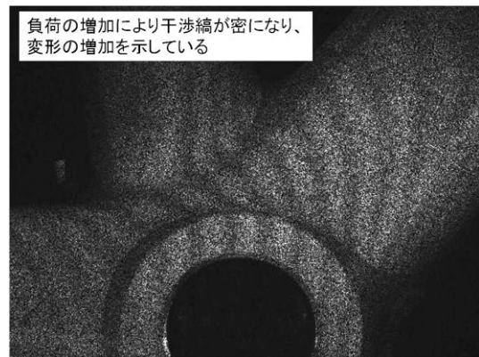
図10 荷重0~3.5kgfの干渉縞画像
